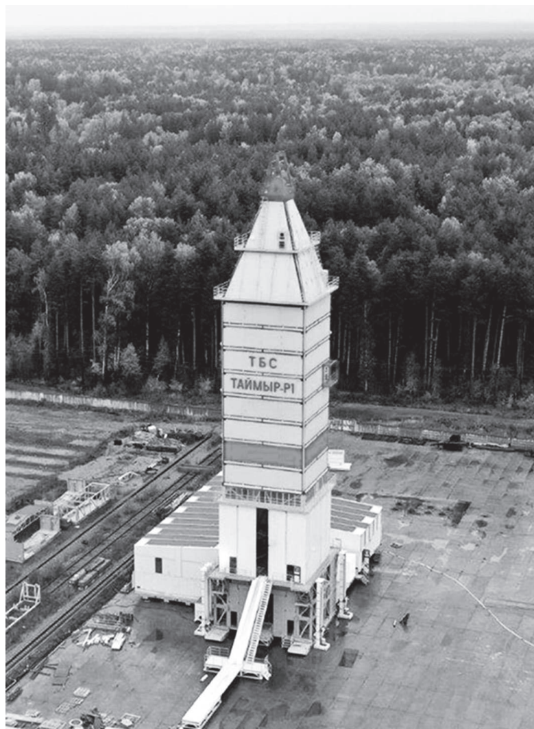
Контрольная сборка буровой установки БУ УСПК 6000/400 ЭРА «Таймыр-Р1» в п. Буланаш / фото: Ольга Миславская
